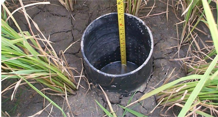
Photo 2. Tube en plastique perforé dans le champ pour mesurer la hauteur de la nappe phréatique en-dessous de la surface du sol. Quand le niveau de la nappe atteint 15 cm en-dessous de la surface du sol, la prochaine re-irrigation est faite jusqu'à atteindre la hauteur de 5 cm au-dessus de la surface du sol
